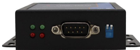
图 9 拨码开关 RS485 状态
