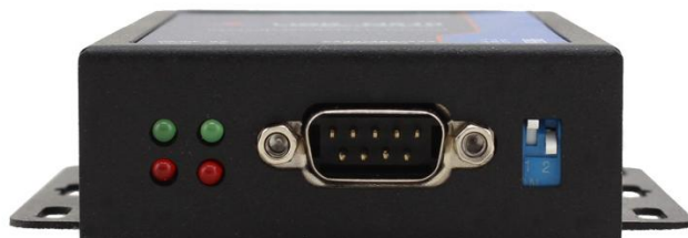
图 10 拨码开关 RS422 状态
