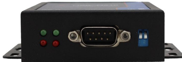
图 8 拨码开关 RS232 状态
