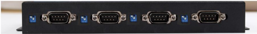
图 13 拨码开关 RS422 状态
