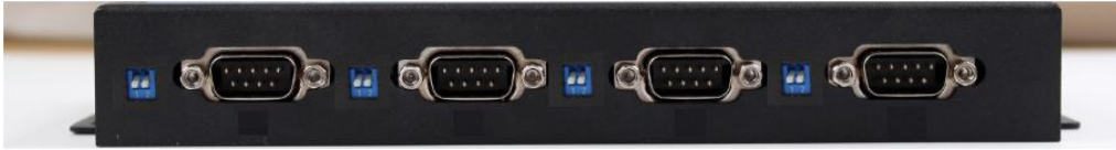
图 11 拨码开关 RS232 状态
