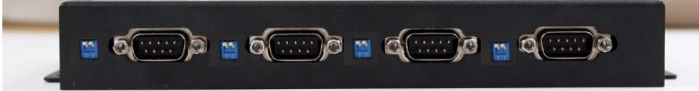
图 12 拨码开关 RS485 状态
