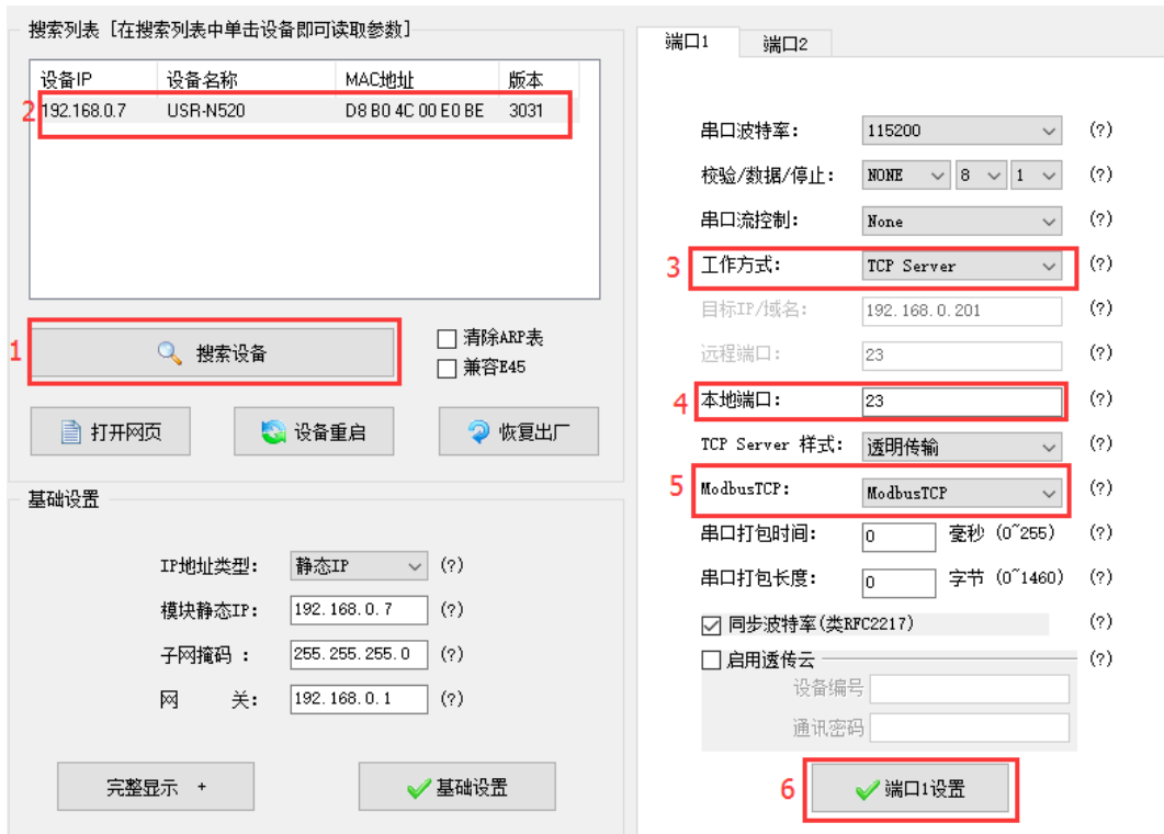
图40 Modbusrtu 转 Modbus tcp
